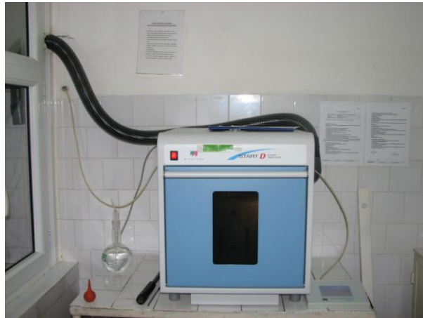
Cuptor cu microunde START D - folosit pentru mineralizarea probelor, în vederea determinării metalelor
