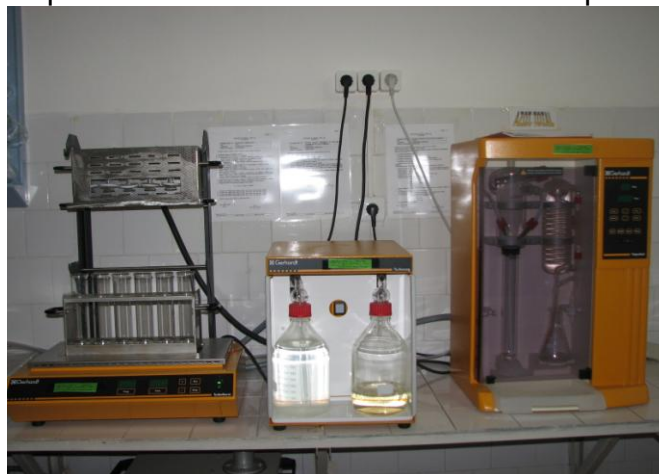
Sistem GERHARD pentru determinarea azotului total din probele de apă și sol.
