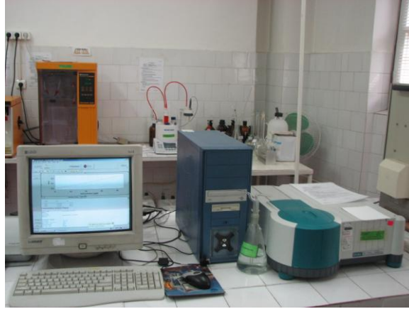
Cuptor cu microunde START D - folosit pentru mineralizarea probelor, în vederea determinării metalelor
